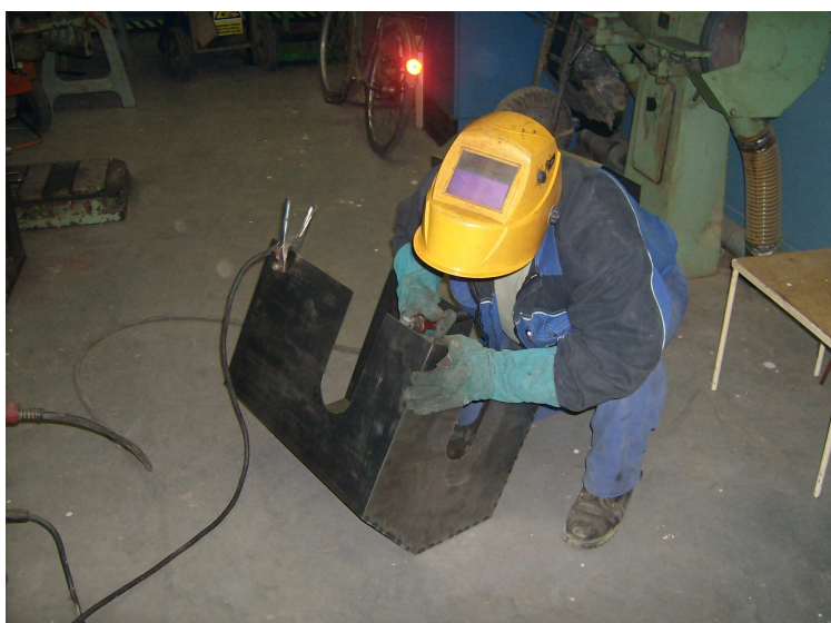
Po zhotovení otvorů bylo provedeno nahýbání pláště krytů a následně svaření v celek.
