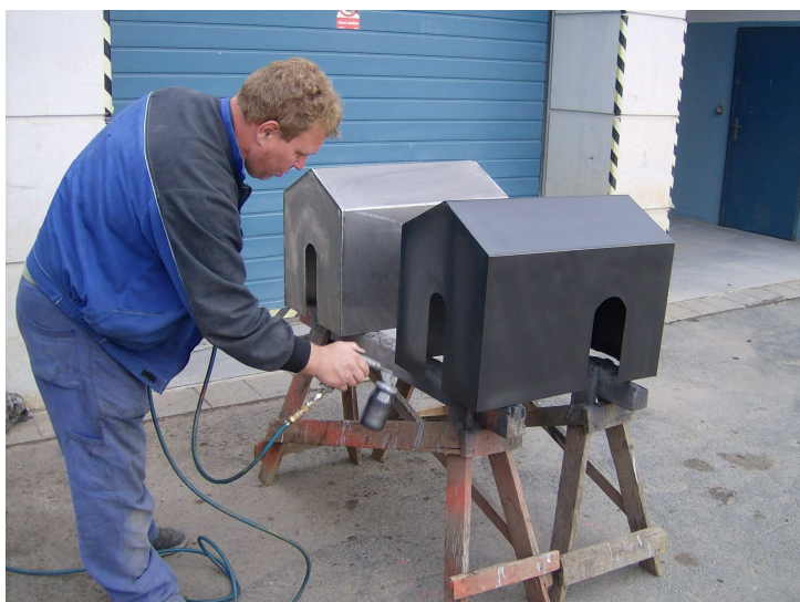
Nástřik krytů barvou z vnitřní i vnější strany Pro nástřik byla zakoupena barva pro použití bez nutného předešlého základního nátěru.
