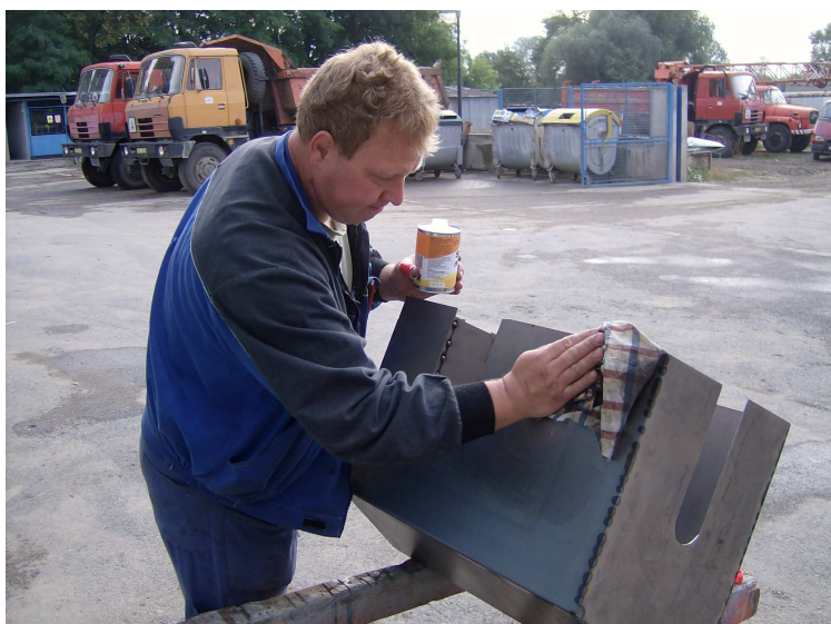
Odmaštění plechů a následné obroušení svárů
