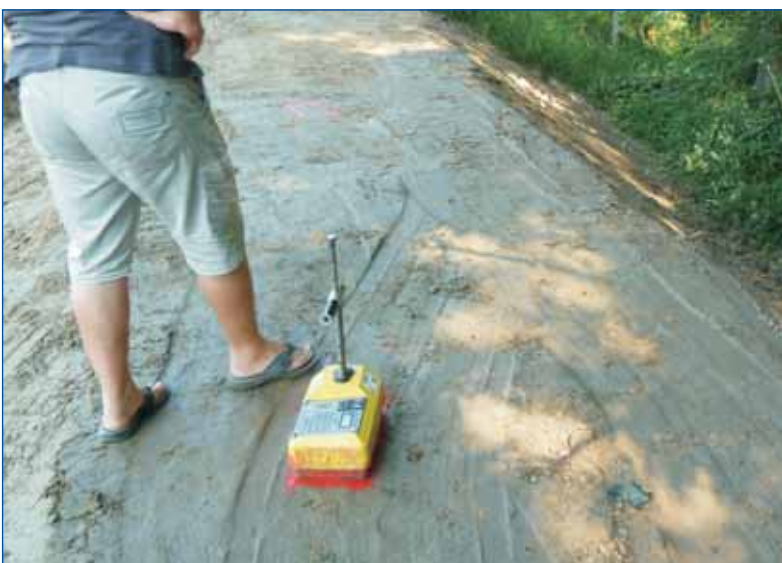
Měření míry zhutnění radiometrickou sondou
